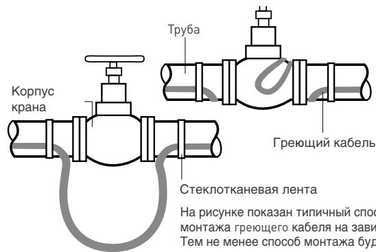
На рисунке показан типичный способ монтажа греющего кабеля на задвижку. Тем не менее способ монтажа будет отличаться в каждом конкретном случае в зависимости от формы задвижки и длины греющего кабеля.
